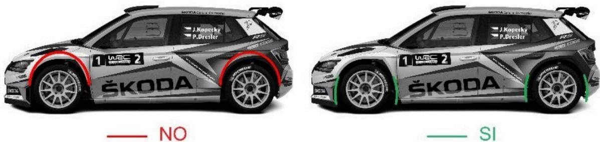
Esquema 2: La diferencia entre la medida A y la medida B no puede ser superior a 5 mm.
